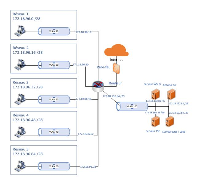
Dans un premier temps, un routeur sera mis en place afin de connecter les différents réseaux entre eux, ensuite plusieurs réseaux seront organisés et découpés en différents Vlan. De plus, des switch (24 ports Gigabit Ethernet) seront installés afin de gérer chaque vlan et de rediriger
